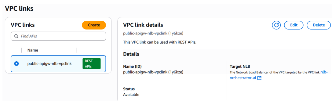
Figura 4.4: VPC Link configurado para la conexión entre el recurso de Amazon API Gateway (3.2.1.2) y el recurso Amazon Network Load Balancer (3.2.1.8) creados.
